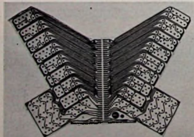
Geëtste schakeling op filmdrager voor een 6-bit code-omzetter in een Plessey-radarapparaat. Het geëtste koperen bedradingspatroon is met „Teflon” FEP fluorkunststof geïsoleerd, terwijl de blank gebleven aansluitingen (langs de middellijn van de schakeling) worden verguld.
