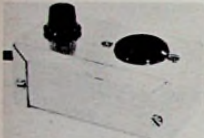
Fig. 17. Behuizing van de wisselstroom-regelaar.
